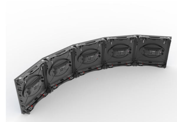
Rückseitig Würfel mit 5x18° aktiven LED-Modulen
